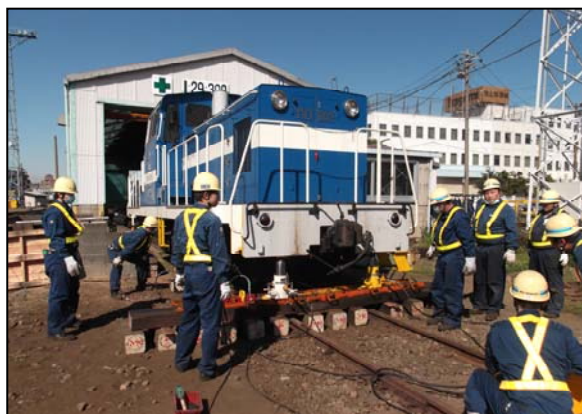
脱線した機関車を横移動ジャッキで持ち上げ レール上に載線させる訓練風景
